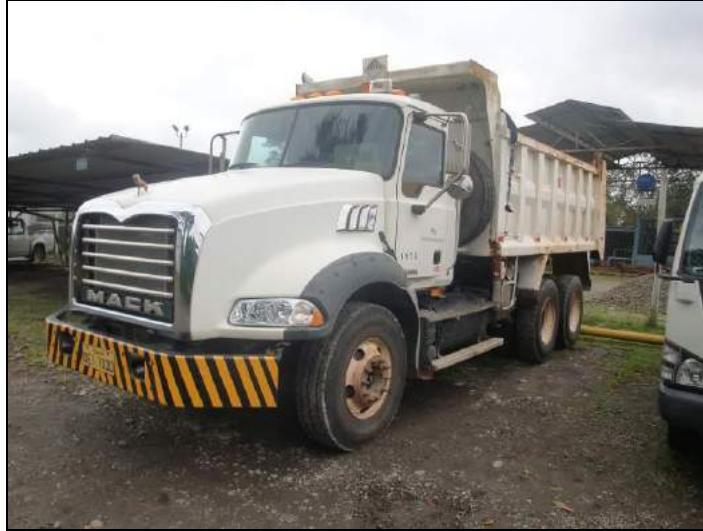
FIGURA 7-5 VOLQUETA MACK PARA EL TRANSPORTE DE SUELOS CONTAMINADOS
